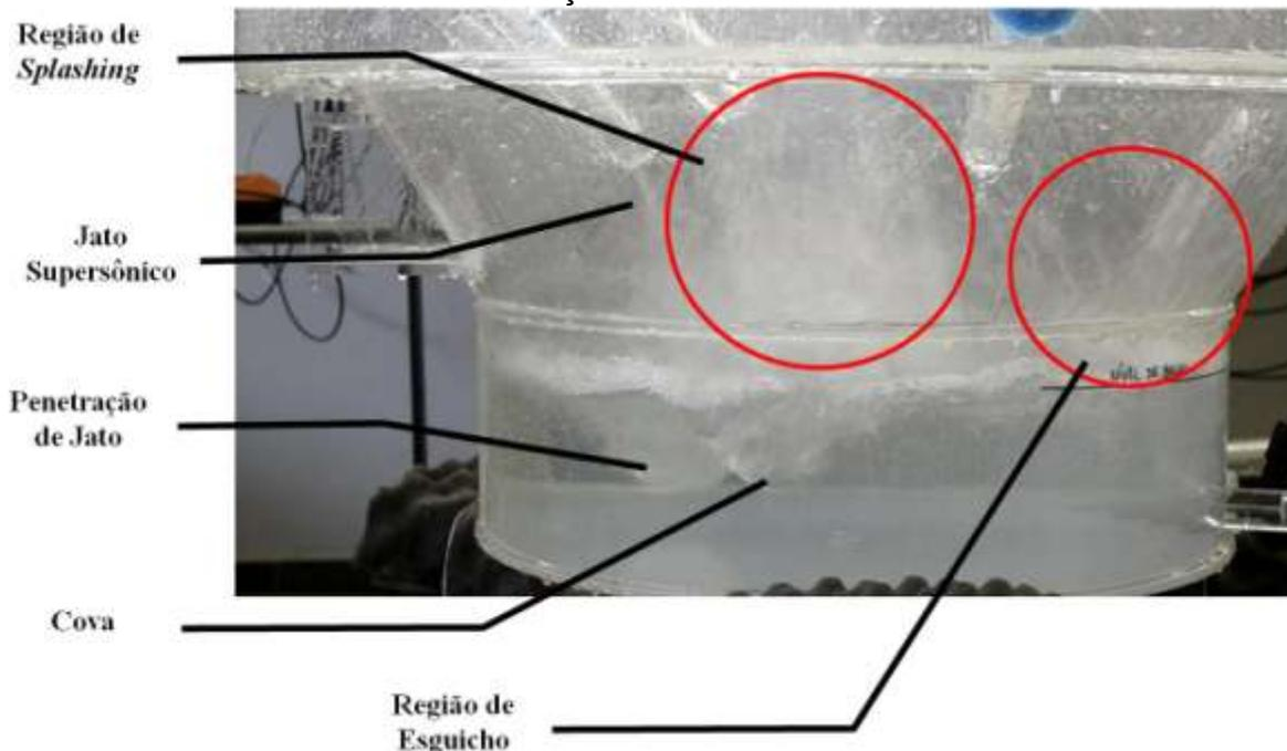
Figura 8 – Comportamento da interação jato supersônico banho metálico no EOF.
